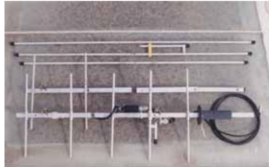
Foto 5: Antena desmontada para transporte
