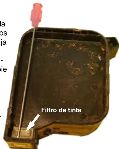
Cartucho con un lateral quitado y sin su esponja. Podemos apreciar el filtro y hasta donde debe llegar la aguja.
